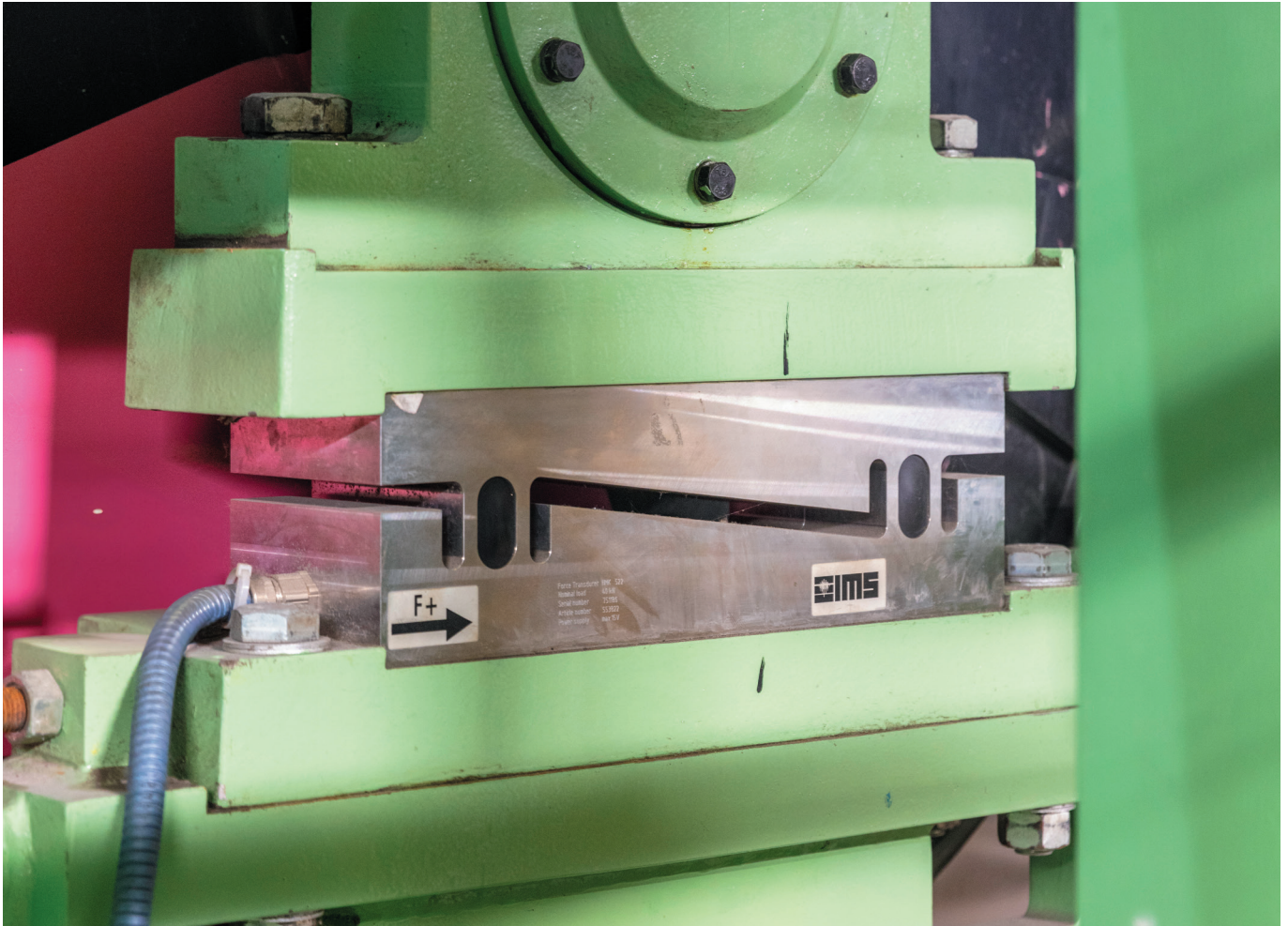
Abbildung 2: StripKraft HMK in einer Fertigungslinie in Betrieb
